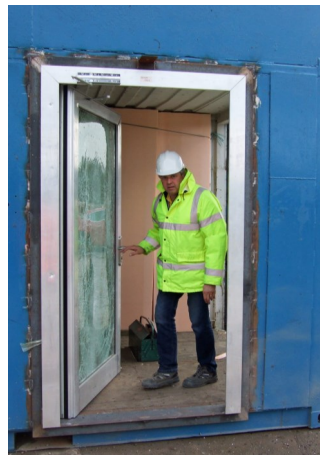
Aluminiumtür war nach dem Test 100 kg | 15 m voll funktionsfähig. Hervorragend geeignet als Tür in Flucht- und Rettungswegen. Aluminium door was fully operable after the test, 100 kg | 15 m. Door can be used in escape and emergency routes.
