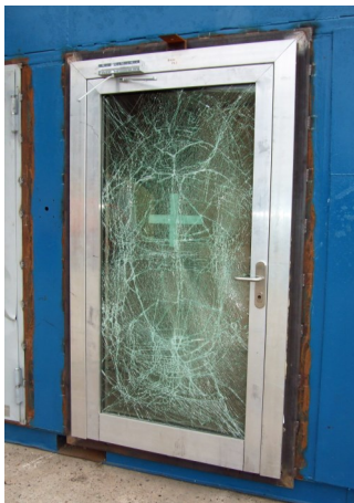
Aluminiumtür nach dem Test, 50 kg | 15 m. Verglasung kaum durchgebogen. Aluminium door after the test 100 kg | 15 m, the glazing was hardly bent.
