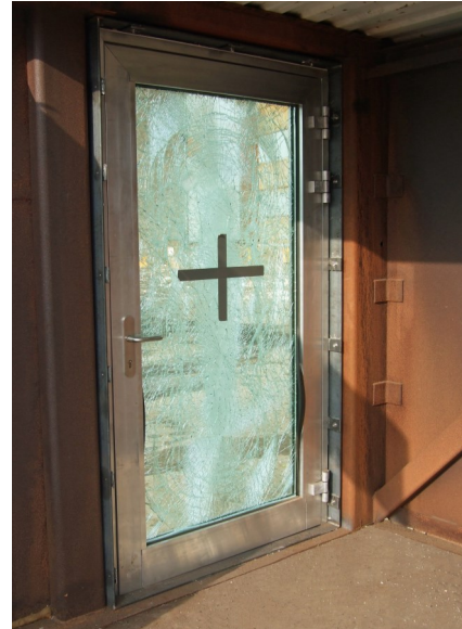
Innenansicht, Tür nach dem Test 100 kg|15 m, kein Splitterabgang GSA 2 (beidseits geprüft). Interior view, door after the test 100 kg|15 m, no splinters GSA 2.
