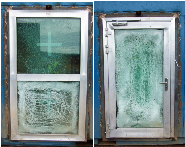
Foto links: 2 Aluminiumfenster, Festfelder, übereinander angeordnet. Test erfolgreich bestanden. Foto rechts: großflächig verglaste Aluminiumtür nach dem erfolgreichen Sprengtest.
